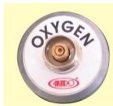
5. **Oxygen Wall outlet** atau umumnya disebut oksigen dinding, perlu diperhatikan bahwa pada bagian tengah oksigen dinding ini adalah katup saluran oksigen, jadi pada waktu memasang Flow Meter perhatikan bahwa pin saluran oksigen di flow meter tepat ditengahnya sehingga dapat menekan katup saluran oksigen yang ada ditengahnya agar oksigen bias mengalir ke flow meter.
